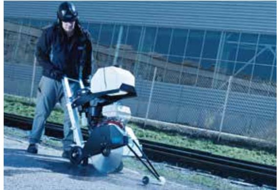
Los discos diamantados de **TYROLIT PREMIUM ★★★** se presentan en los siguientes tamaños de buje: 25.4, 50 y 60, los discos con buje de inferior diámetro poseen anclaje para perno de arrastre. Los discos diamantados **TYROLIT STANDARD ★★** se ofrecen con un diámetro interior de 50 mm. con una arandela de reducción de 50 mm. a 25,4 mm. y agujero de arrastre marcado.
